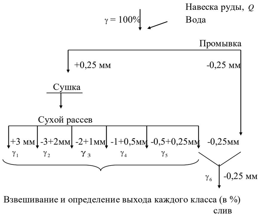
Рис. 3.2. Схема мокросухого ситового анализа
